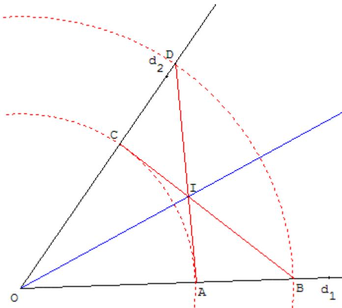
Soit un angle de sommet  $O$  formé par deux demi-droites  $(d_1)$  et  $(d_2)$  ayant ce point pour origine. Placer deux points  $A$  et  $B$  sur un des côtés  $(d_1)$  de l'angle. Reporter les longueurs  $OA$  et  $OB$  sur la deuxième demi-droite  $(d_2)$  en y plaçant les points  $C$  et  $D$  tels que  $OC = OA$  et  $OD = OB$ . Tracer les deux segments  $[AD]$  et  $[BC]$ . Ces deux segments se recoupent en  $I$ .
