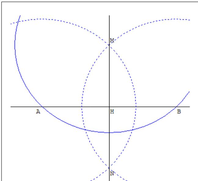
Un cercle de centre  $M$  rencontre la droite  $(d)$  en  $A$  et  $B$ . Deux autres cercles de même rayon de centres  $A$  et  $B$  passent par  $M$  et se recoupent en  $N$ . La perpendiculaire est la droite  $(MN)$ .
