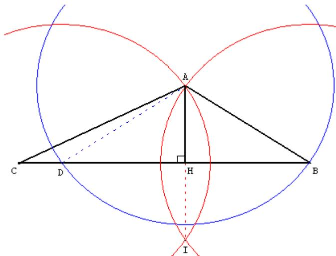
Pour construire des droites parallèles ou perpendiculaires à la règle et au compas il faut souvent se ramener à la construction de la médiatrice d'un segment.
