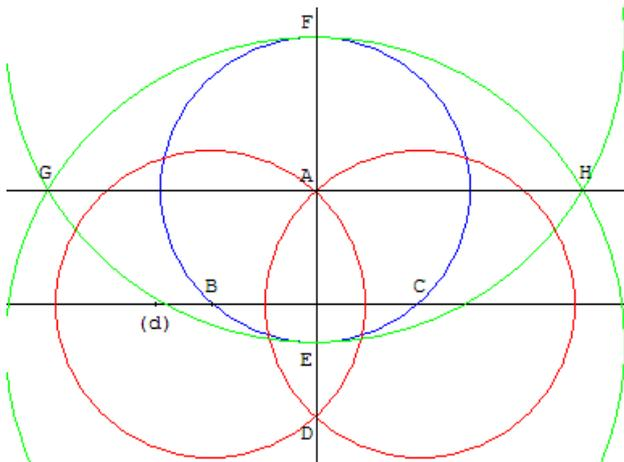
Il est possible d'utiliser deux fois la construction de la médiatrice du paragraphe 1 pour tracer la perpendiculaire à  $(d)$  passant par le point A, puis d'élever en A la perpendiculaire à cette droite :
