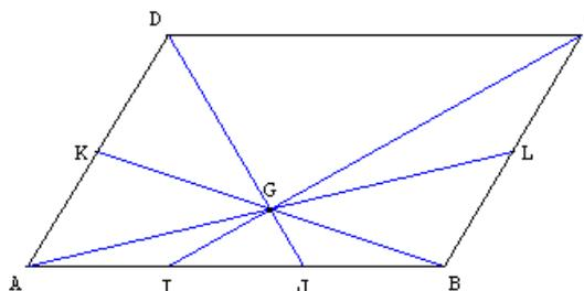
On considère un parallélogramme  $ABCD$ .  $K$  est le milieu de  $[AD]$ ,  $L$  le milieu de  $[BC]$ . Les diagonales du parallélogramme  $ABLK$  se coupent en  $G$ . Les droites  $(CG)$  et  $(DG)$  déterminent sur le côté  $[AB]$  deux points  $I$  et  $J$  qui le partagent en trois parties égales.
