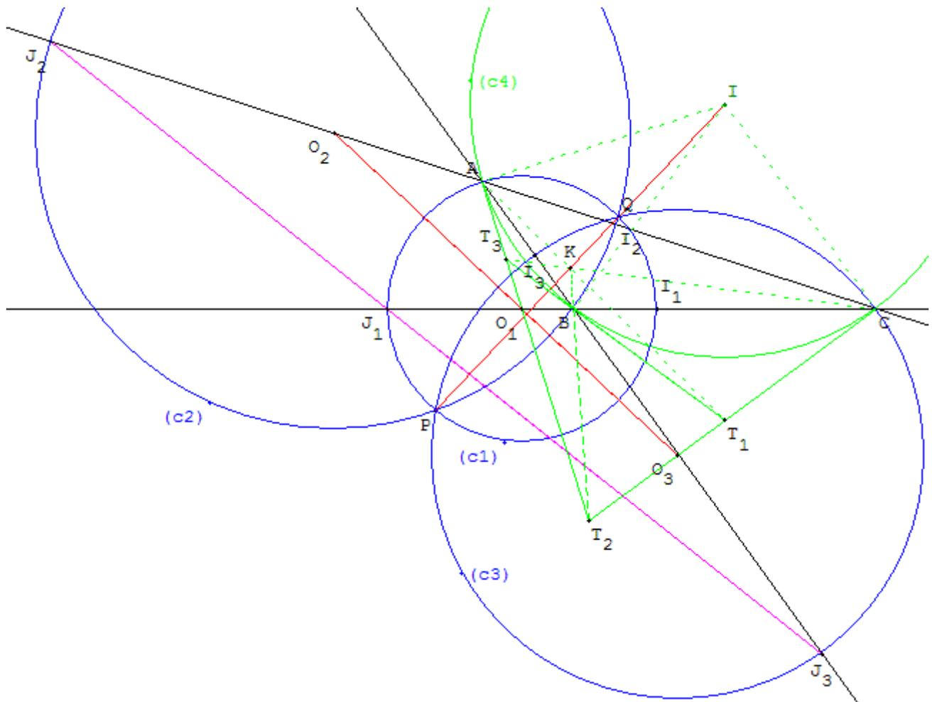
Le rayon  $(AI)$  de  $c_4$  est perpendiculaire au rayon  $(AO_1)$  de  $c_1$ . Les cercles  $c_1$  et  $c_4$  sont orthogonaux. De même  $(BO_2)$  et  $(CO_3)$  sont tangentes au cercle circonscrit.
