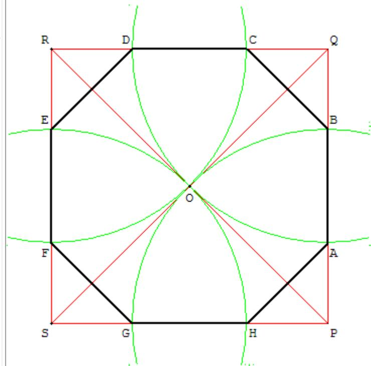
Tracer les diagonales du carré et marquer le centre O du carré, point d'intersection des diagonales.
