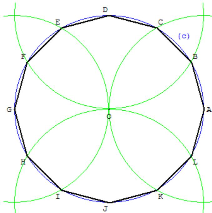
Dans le cercle (c), de centre O, tracer deux diamètres [AG] et [DJ] perpendiculaires.
