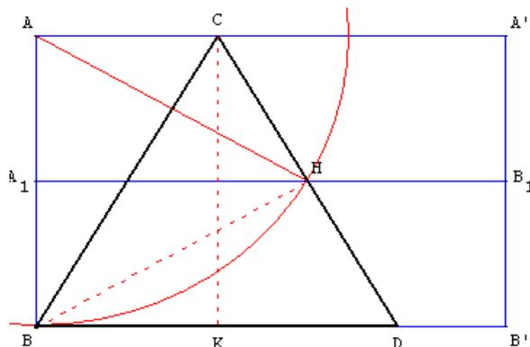
La construction du triangle équilatéral de hauteur  $h$  se fait en plaçant un des sommets au coin d'un rectangle de largeur  $h$ . Le pied H de la hauteur  $[BH]$  est situé sur la médiatrice  $(A_1B_1)$  du rectangle. Ce point est aussi situé à une distance  $h$  de A.
