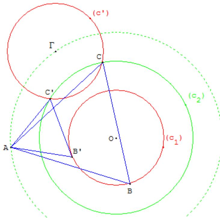
Construire l'image  $(c')$  du cercle  $(c_1)$  par la rotation  $r$  de centre  $A$  et d'angle  $60^\circ$ .
