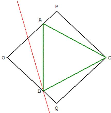
Construire l'image  $(d)$  de la droite  $(OP)$  par la rotation  $r$  de centre  $C$  et d'angle  $60^\circ$ , cette droite image  $(d)$  coupe  $(OQ)$  en  $B$ , puis on obtient le point  $A$  en construisant l'image de  $B$  par la rotation réciproque  $r^{-1}$  de centre  $C$  et d'angle  $-60^\circ$ .
